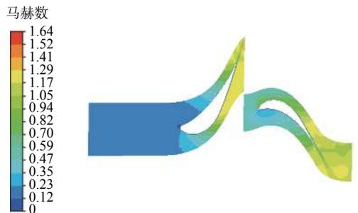
图 5 CFX 马赫数数值模拟结果
