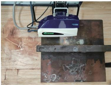
图 8 热处理后的残余应力测试
