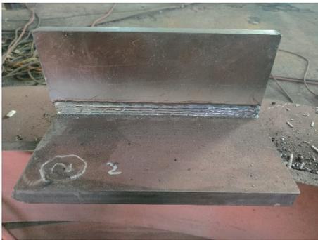
图 3 T 型焊接接头试件
