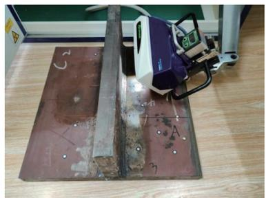
图 6 底板上表面的残余应力测试
